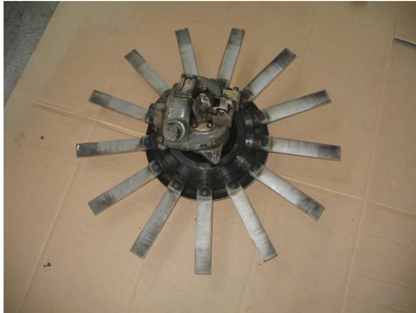
Сл. 30. - Изглед Репног ротора (фаб.бр. 341А.33.5100.05, сер.бр. М-494) у склопу са репним редуктором (фаб.бр. 341А.33.5500.07, сер.бр YU-126) након удеса
