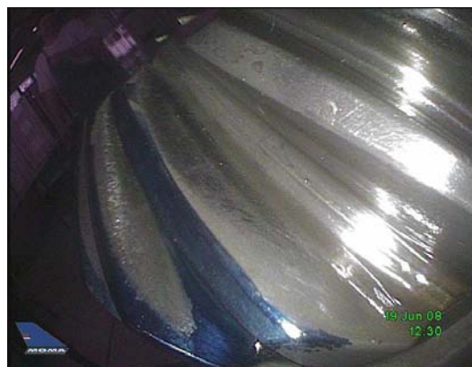
Сл. 42. - Исправна слика налегања бокова погонског и гоњеног зупчаника улаза снаге главног редуктора (фаб.бр. 341А.32.1000.06, сер.бр.АСГ-1098) након удеса хеликоптера
