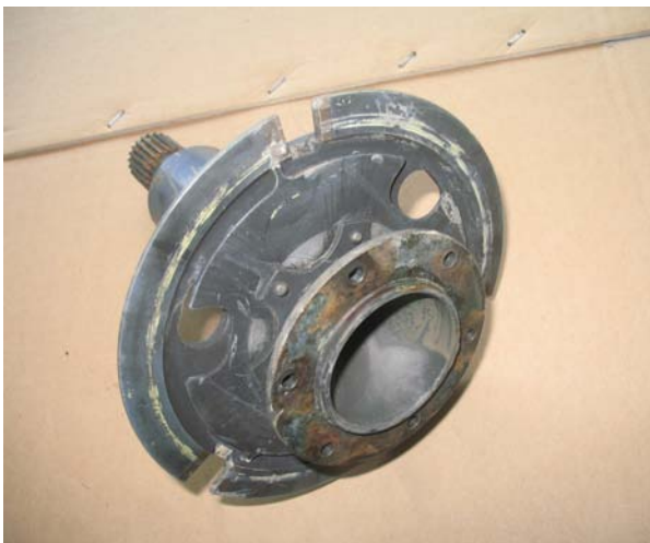
Сл. 18. - Изглед оштећеног подклопа вратила момента (торк вратила) (фаб.бр.341.А.35.0162.09, сер.бр. YU-206)
