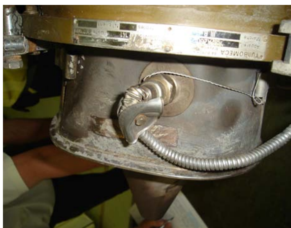
Сл. 10. - Детаљи спољашњих оштећења мотора ASTAZOU III B (сер.бр.141)
