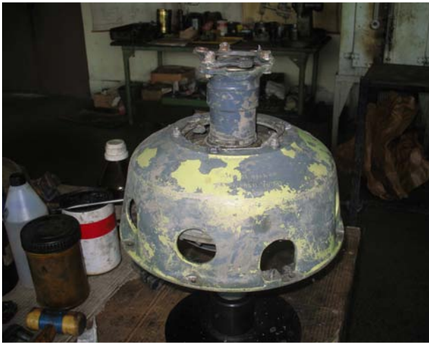
Сл. 16. - Изглед оштећеног склопа квачила (фаб.бр. 341А.35.0002.00, сер.бр YU-182 )
