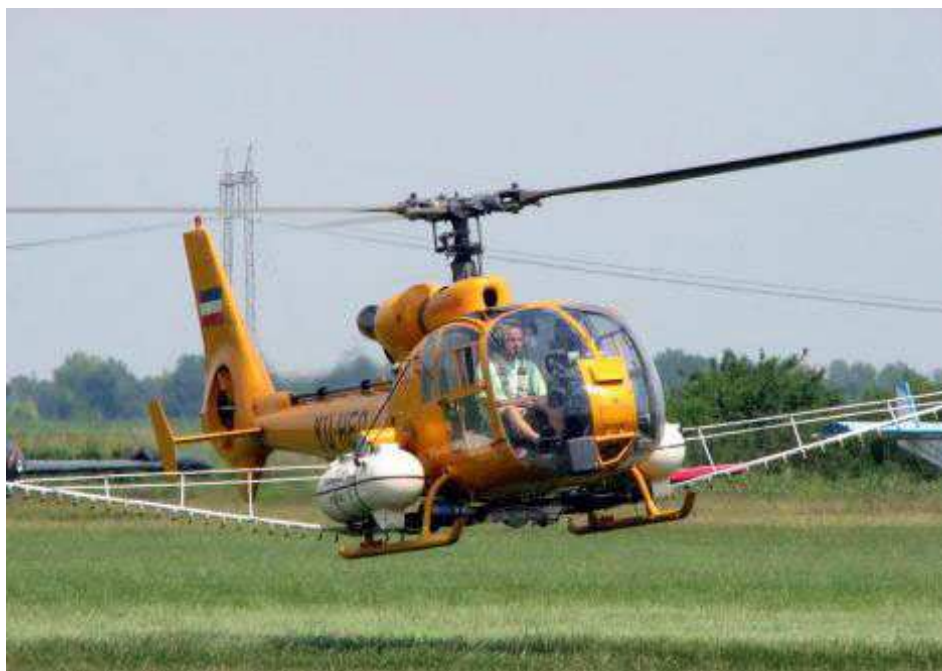
Слика 4. Уграђен систем за распршивање течних хемијских средстава типа ISOLAIR 3700
