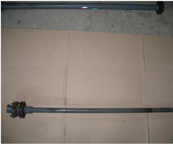
Сл. 51. - Оштећења спојног вратила (фаб.бр. 341А.34.1114.04, сер.бр. М-179) након удеса хеликоптера
