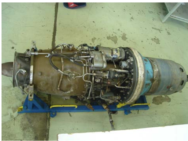
Сл. 9. - Спољашња оштећења мотора ASTAZOU III B (сер.бр.141)
