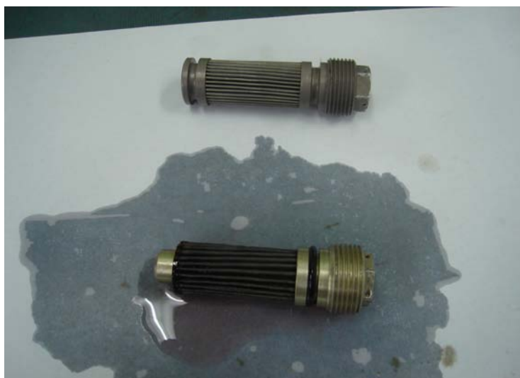
Сл. 34. - Изглед исправног и оштећеног филтера (одлетована прирубница на врху)
