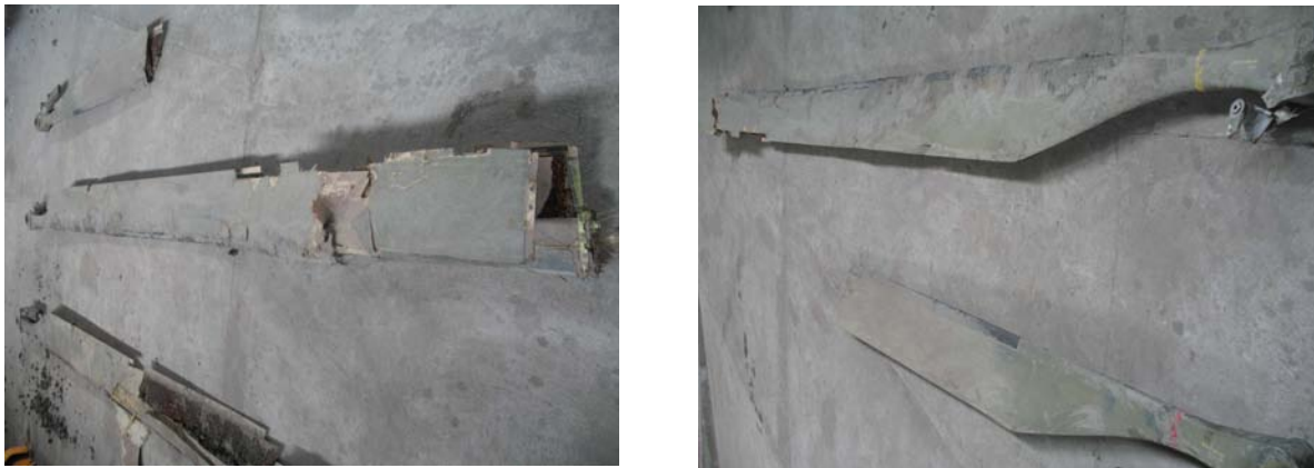
Сл. 2. - Изглед оштећења на лопатицама хеликоптера
