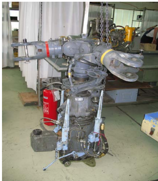
Сл. 27. - Изглед оштећене главчине главног ротора (фаб.бр.341А.31.0001.11)
