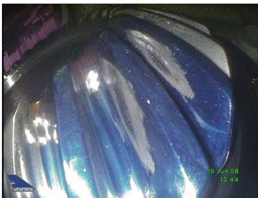
Сл. 43. - Исправна слика налегања бокова погонског и гоњеног зупчаника излаза снаге за репни ротор главног редуктора (фаб.бр. 341А.32.1000.06 , сер.бр. АСГ-1098) након удеса хеликоптера
