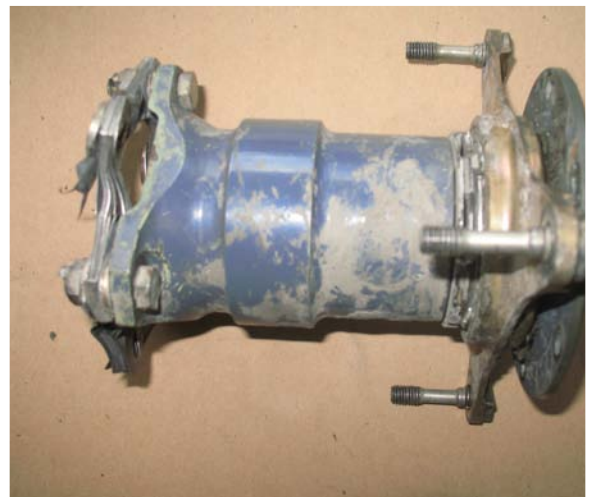
Сл. 19. - Изглед оштећене једносмерне спојнице (фаб.бр. 341А.35.0060.00, сер.бр. YU-188)
