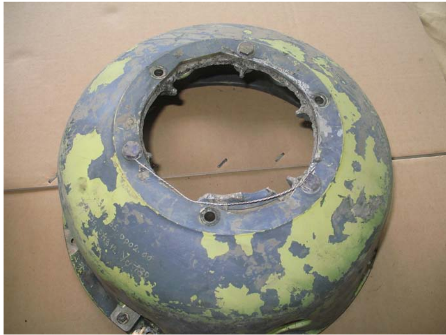
Сл. 20. - Изглед оштећеног подскопа кућишта (фаб.бр. 341А.35.0112.01, сер.бр. YU-182)
