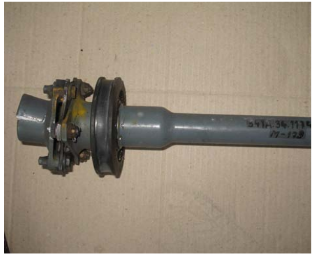
Сл. 51. - Оштећења спојног вратила (фаб.бр. 341А.34.1114.04, сер.бр. М-179) након удеса хеликоптера
