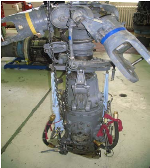
Сл. 4. - Изглед оштећене главчине главног ротора са главним редуктором
