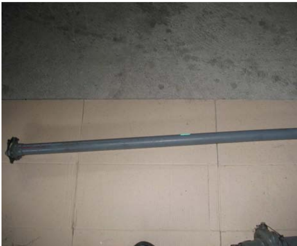
Сл. 50. - Оштећења хоризонталног вратила (фаб.бр. 341А.34.1106.02, сер.бр. је на откинутом делу који није пронађен на месту удеса) након удеса хеликоптера
