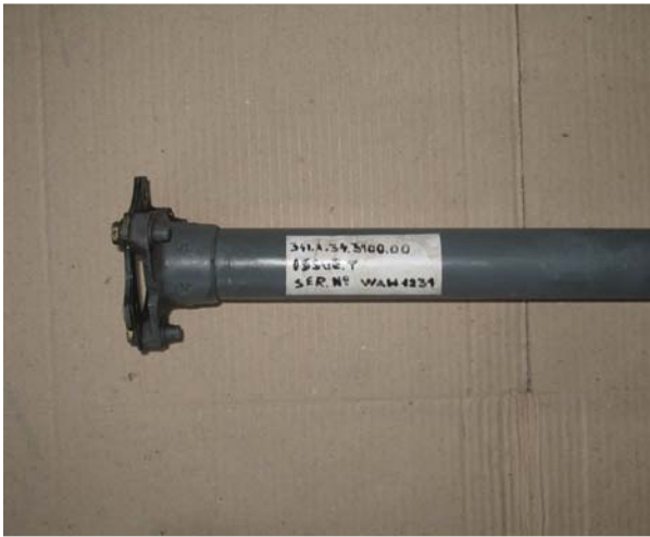
Сл. 49. - Оштећења на косом вратилу (фаб.бр. 341А.34.3100.00, сер.бр. WAM-1231) након удеса хеликоптера
