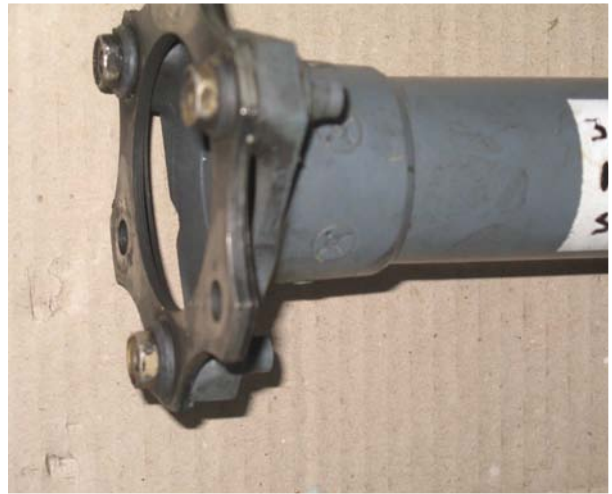
Сл. 49. - Оштећења на косом вратилу (фаб.бр. 341А.34.3100.00, сер.бр. WAM-1231) након удеса хеликоптера
