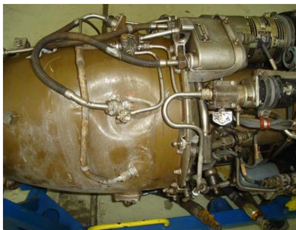
Сл. 10. - Детаљи спољашњих оштећења мотора ASTAZOU III B (сер.бр.141)
