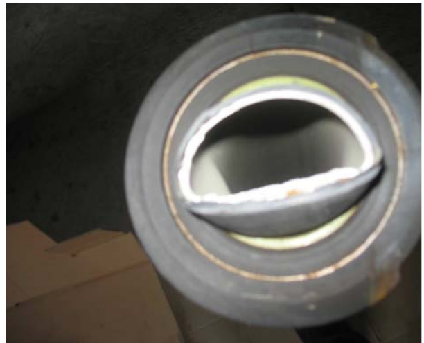
Сл. 50. - Оштећења хоризонталног вратила (фаб.бр. 341А.34.1106.02, сер.бр. је на откинутом делу који није пронађен на месту удеса) након удеса хеликоптера
