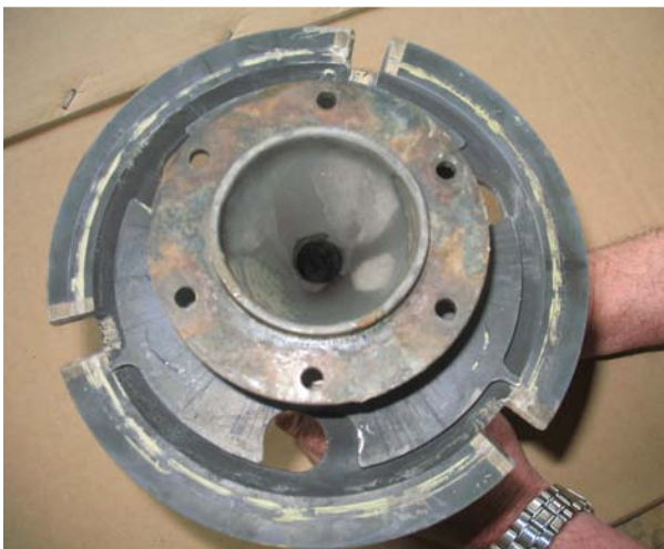
Сл. 23. - Изглед оштећења диска подскопа вратила момента (торк вратила) (фаб.бр. 341А.35.0162.09, сер.бр. YU-206)
