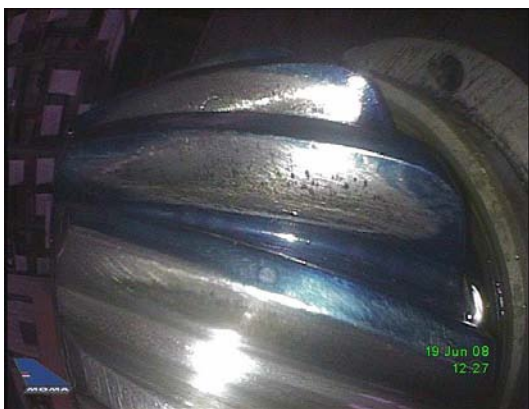
Сл. 42. - Исправна слика налегања бокова погонског и гоњеног зупчаника улаза снаге главног редуктора (фаб.бр. 341А.32.1000.06, сер.бр.АСГ-1098) након удеса хеликоптера
