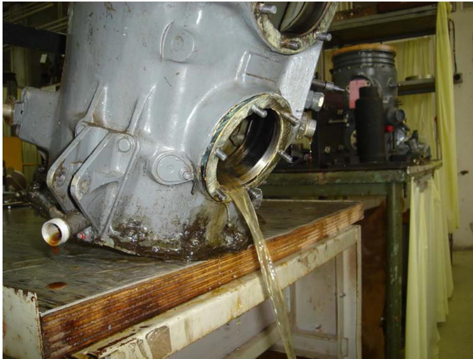
Сл. 38. - Присуство воде у главном редуктору (фаб.бр. 341А.32.1000.06, сер.бр. АСГ-1098) након удеса хеликоптера
