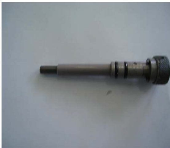
Сл. 41. - Изглед неоштећених делова система за уље (магнетни чеп и филтер) главног редуктора (фаб.бр. 341А.32.1000.06 , сер.бр. АСГ-1098) након удеса хеликоптера
