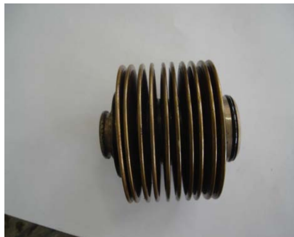
Сл. 41. - Изглед неоштећених делова система за уље (магнетни чеп и филтер) главног редуктора (фаб.бр. 341А.32.1000.06 , сер.бр. АСГ-1098) након удеса хеликоптера
