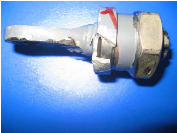
Сл. 28. - Изглед оштећења, деформација и ломова делова Главчине главног ротора (фаб.бр. 341А.31.0001.11, сер.бр. М-444) након удеса
