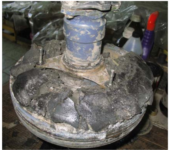
Сл. 17. - Изглед оштећеног подклопа центрифугалне спојнице (фаб.бр. 703А.35.0000.12 , сер.бр YU-1595)
