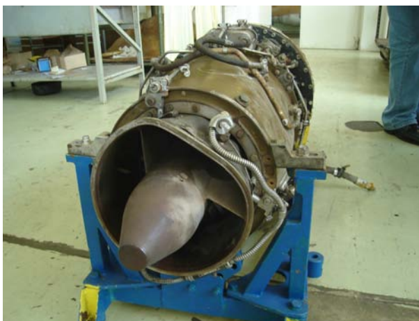
Сл. 9. - Спољашња оштећења мотора ASTAZOU III B (сер.бр.141)
