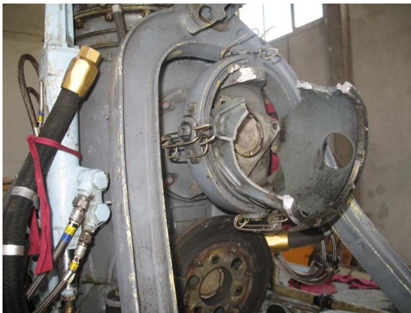
Сл. 40. - Лом улазног кућишта са карданским прстеном и деформацијом "А" рама главног редуктора (фаб.бр. 341А.32.1000.06, сер.бр. АСГ-1098) након удеса хеликоптера
