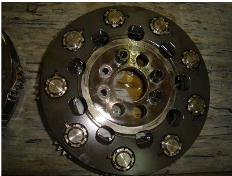
Сл. 39. - Лом чаура другог степена сателита у главном редуктору (фаб.бр. 341А.32.1000.06, сер.бр. АСГ-1098) након удеса хеликоптера
