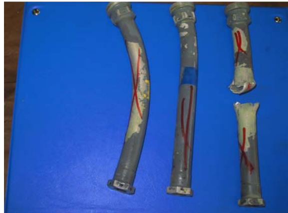
Сл. 28. - Изглед оштећења, деформација и ломова делова Главчине главног ротора (фаб.бр. 341А.31.0001.11, сер.бр. М-444) након удеса
