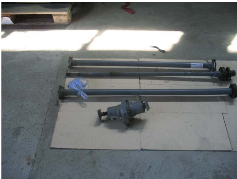
Сл. 48. - Изглед склопа трансмисионих вратила након удеса хеликоптера
